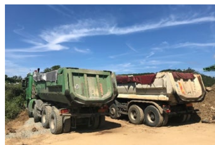
Photo 14 : filet sur des camions transportant des déblais, chantier Centre maintenance du Neobus. Crédit : CCI-NC.
